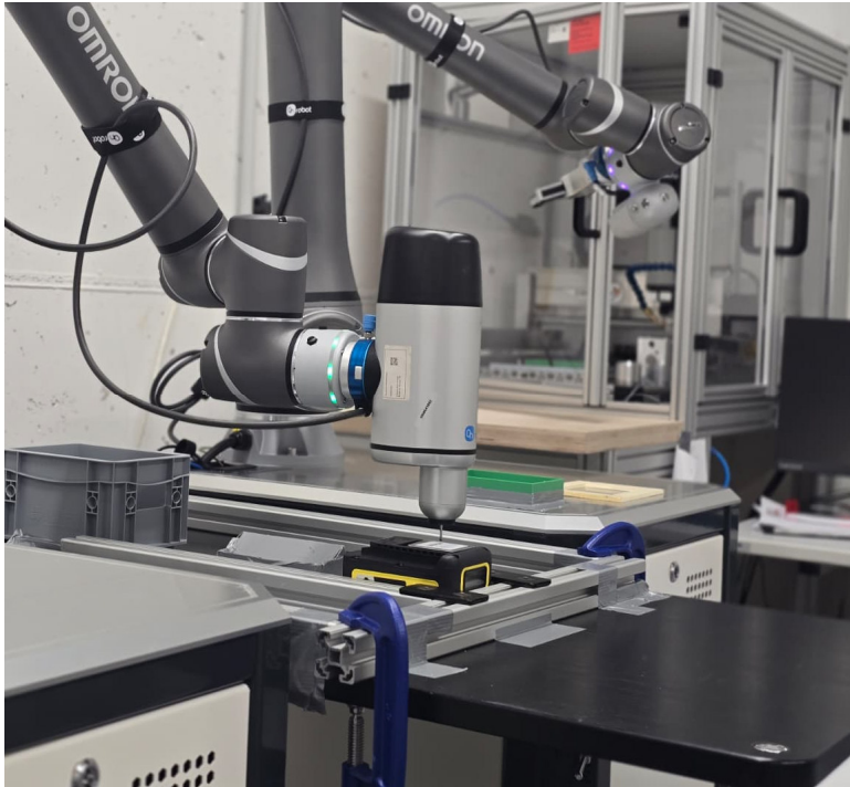
Abb. 2 Automatisierte Demontage eines Batterie-Moduls im Fraunhofer IWKS Robotik-Lab. © Fraunhofer IWKS
